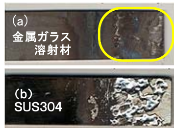
(図4) 高耐食性を利用した例 耐鉛フリーハンダ用コーティング (500°C96時間の浸漬試験) (4) (a) Fe基金属ガラスの溶射材、 (b) 比較材(SUS304)
