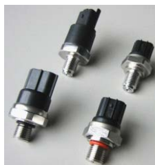
(図3) センサへの応用例 (Zr基またはNi基金属ガラス製ダイヤモンドプラムを用いた圧力センサー (3) )
