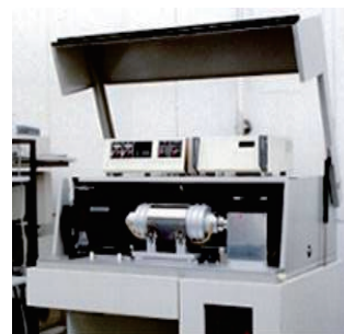
図1. レーザーフラッシュ熱物性測定装置。金属、セラミックスなどの熱拡散率、比熱、熱伝導率を800℃まで測定できます。
