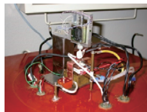
(a)急速加熱制御・金属ガラス用ナノインプリント装置
