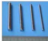
図1) 金型鑄造法で作製した棒材の例
