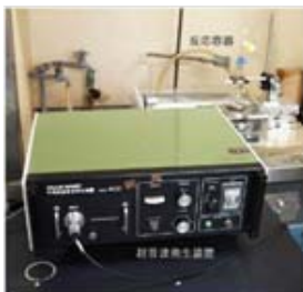
図1) 超音波照射装置の概観。 手前の発生装置に圧電素子の振動子を接続し、後ろの水槽中で超音波を照射します。
