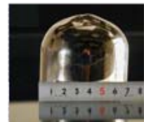
図2) 水焼入れ法とその方法で作製した金属ガラス
