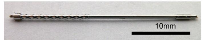
図2 ローター+カップリングロッドの一体成型(金属ガラス)
