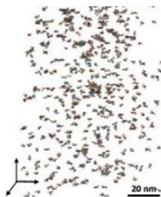
【図1】10MeV ヨウ素イオン照射によってAl-Cu系合金（ジュラルミン）内に生成された直径3nmの微細析出物の3次元アトムプローブ解析像。（電子中央研究所と共同研究）特異な析出物形成により合金硬度が向上します。 (T.Mitsuda et al., J. Nucl. Mater. 408, 201-204(2011))
