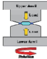
Fig.1 強ひずみ加工法(High Pressure Torsion, HPT)の概略図
