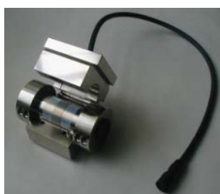
図3 金属ガラスを用いた回転トルクセンサ試作品の外観
