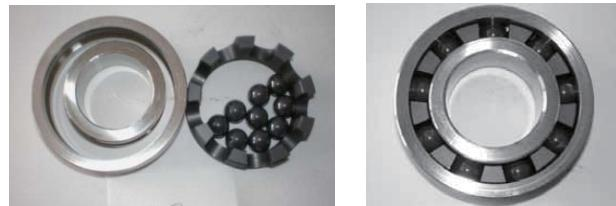
図 Ni基金属間化合物合金製内・外輪、固体潤滑剤とセラミックボール(左)、組立品(右)
