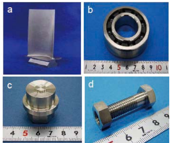
図4 Ni基超・超合金製、(a)タービンブレード、(b)ボールベアリング、(c)鉄系用摩擦攪拌接合ツール、(d)締結部品
