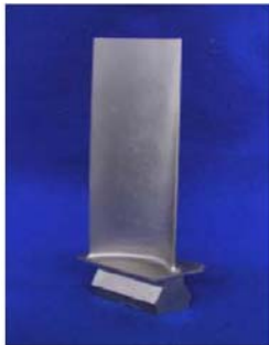
図2) Ni基超超合金製ジェットエンジン用タービンブレード試作品。
