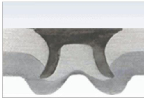
パンチで材料をダイに押し付けて材料そのものを機械的に接合するため、複数の薄板をワンストロークで接合することが可能
