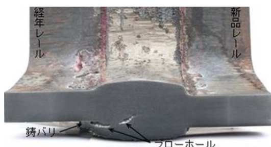
写真1 溶接試験で発生したブローホール ( http://www.rtri.or.jp/rd/news/structure/structur )
