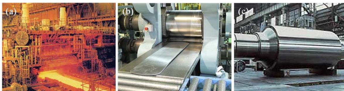
図1 熱間圧延(a)、冷間圧延(b)、圧延ロール(c)
