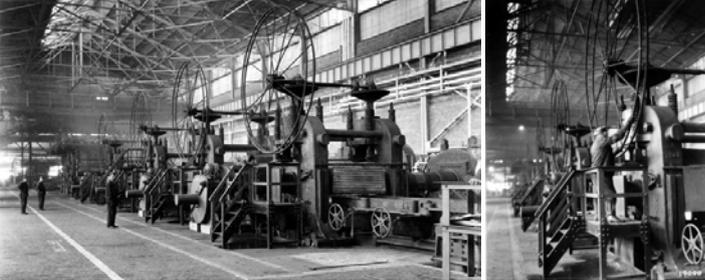
American Rolling Mill Companyが製造した最初の連続圧延機
